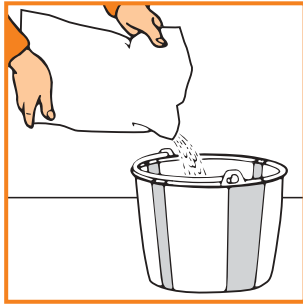
Figure 23 : Disperser l'enduit pour joints dans l'eau
