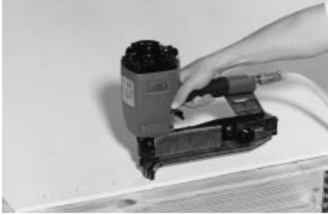
Figure 16 : Agrafeuse pour une fixation manuelle
