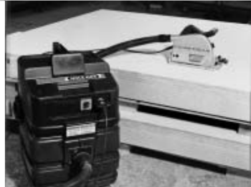
Figure 10 : Scie circulaire portable avec dispositif d'aspiration
