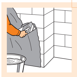
Figure 17 : La plaque FERMACELL s'applique dans le mortier adhésif préalablement étendu sur le canal de cheminée
