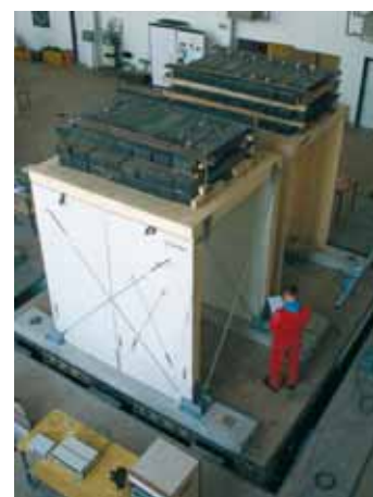
Essai sur table à secousses – arrachement des agrafes après un séisme de type Petrovac.
