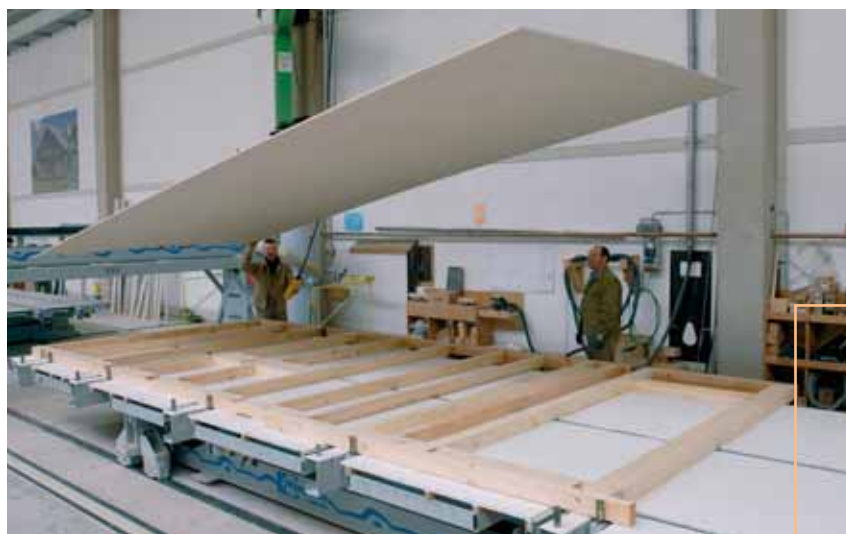
Bâtiment à plusieurs niveaux dans la construction bois avec les plaques de plâtre armé de fibres FERMACELL.
