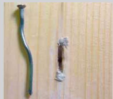
Plastische Verformung des Verbindungsmittels
