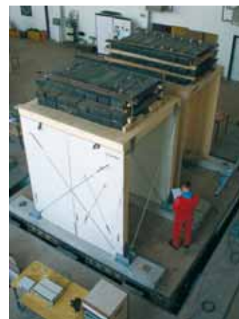
Shake Table Versuche (belastet). Herausziehen der Klammern nach Petrovac.
