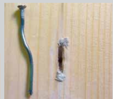
Plastische Verformung des Verbindungsmittels
